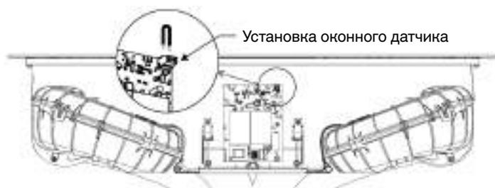
1. Откройте и снимите крышку блока управления двигателем.
