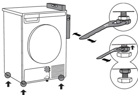
Установите машину в стабильном положении. Выставьте машину по уровню строго горизонтально, выворачивая или вворачивая регулируемые ножки ключом номер 22 (макс. 15 миллиметров). Затем закрутите контргайку ключом номер 17 по направлению к дну машины ↑.
