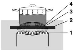
Под стеклокерамической поверхностью (2) размещена индукционная катушка (1), которая генерирует электромагнитное поле (3). Если на конфорку поставить посуду с намагничивающимся дном (4), в дне начинает индуцироваться ток.
